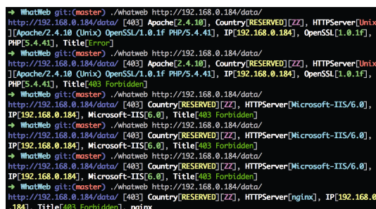
图 8 开启拟态防御功能时的恶意扫描探测结果
