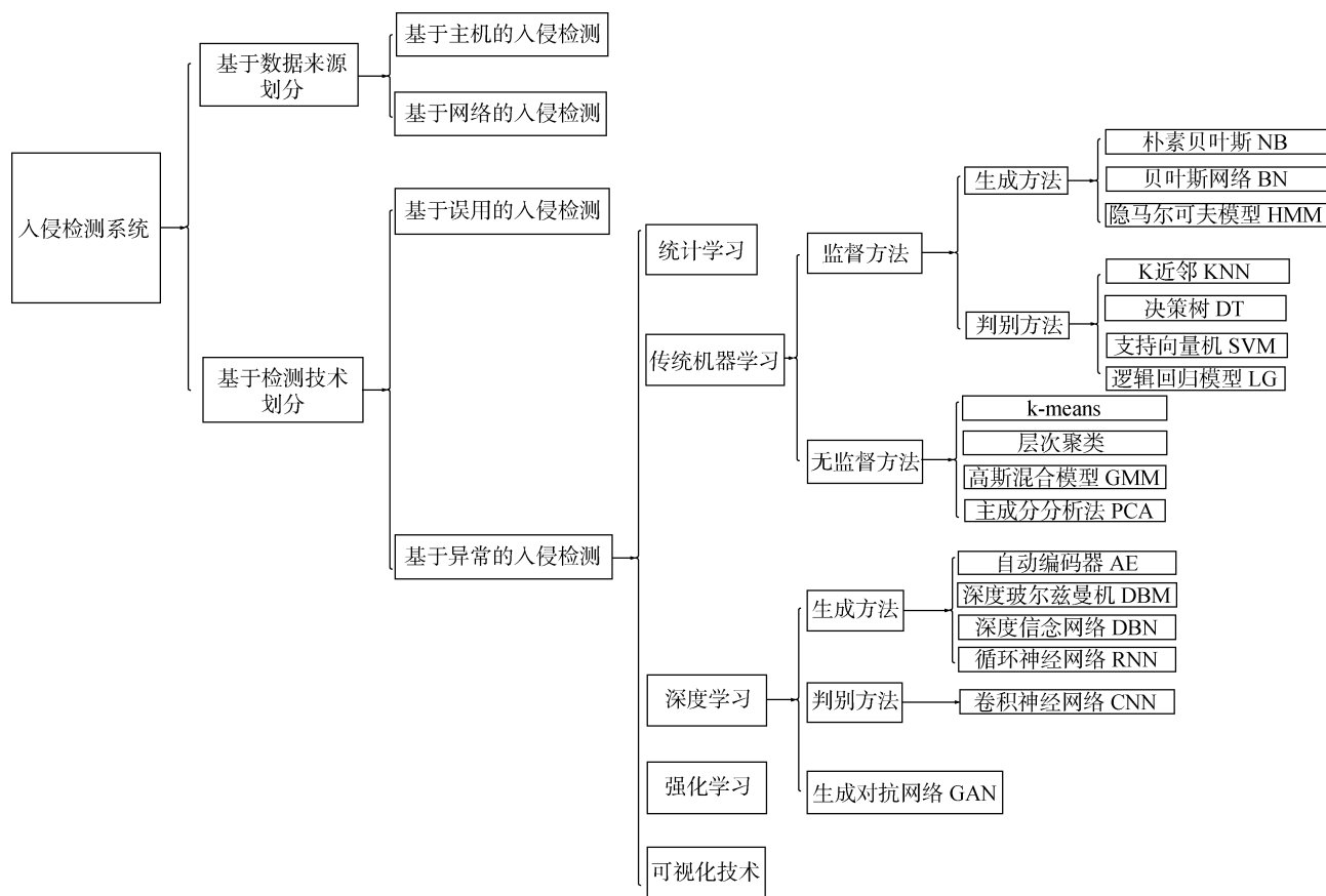
图 1 入侵检测系统构建框架
