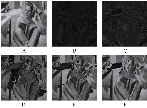
图 4 原始数据直接做取模运算的加密效果
