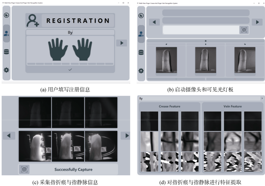
图 11 用户注册流程示意图, (a)输入用户名的注册界面, 用户在此填写注册信息(b)注册过程中可见光源下的手指图像, 用户可以观察图像及时调整手指位置(c)系统成功采集到的手指图像, 上下两行分别用于提取指折痕和指静脉特征信息(d)系统分别找到指折痕和指静脉 ROI 区域, 提取特征信息, 并将特征信息存储到数据库中
