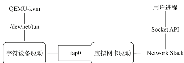
图 3 tap 网卡的工作模式 Figure 3 The working mode of tap network card
