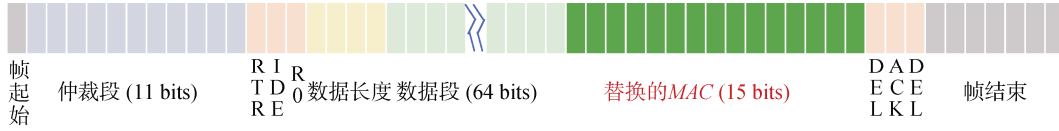
图 2 改进后的 CAN 帧结构
